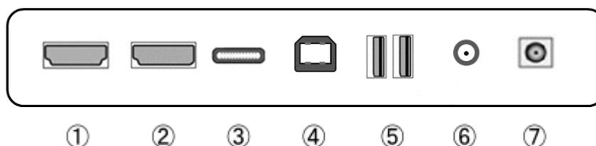
**1 : Port HDMI :** Port compatible HDMI 1.4 (2560 x 1440 à 75 Hz).
