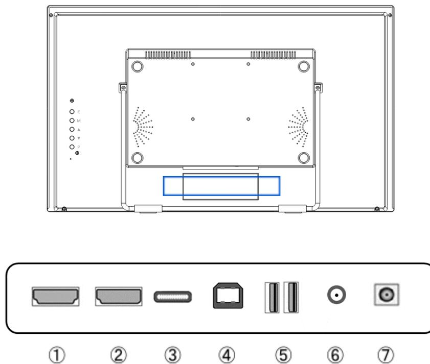
**1: Port HDMI:** compatible HDMI 1.4 (2560 x 1440 à 75 Hz).
