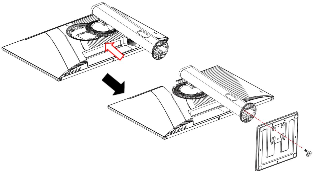
4. Stellen Sie sicher, dass Monitor und Ständer sicher befestigt sind, und heben Sie dann den Monitor langsam an.
