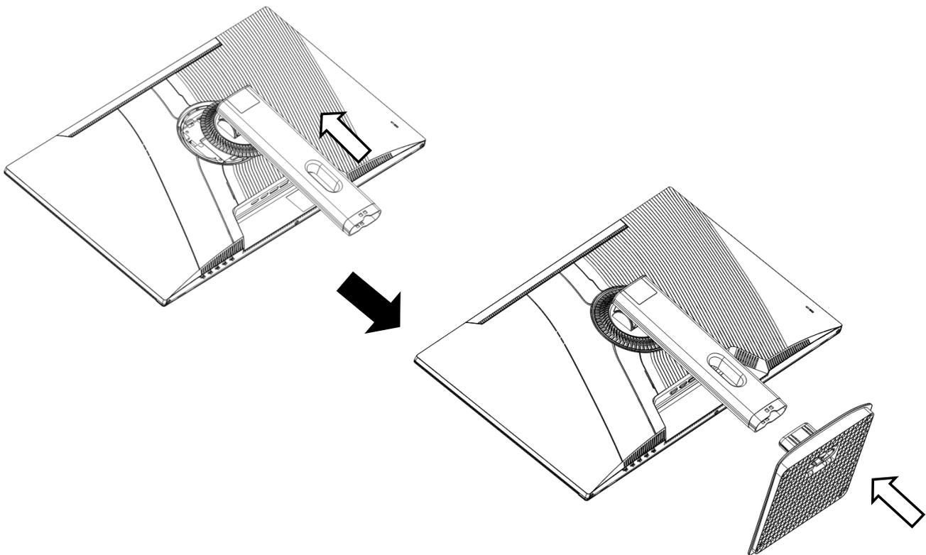
4. Stellen Sie sicher, dass Monitor und Ständer sicher befestigt sind, und heben Sie dann den Monitor langsam an.
