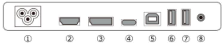
**1 : Netzstecker:** Netzteil Anschluss.
