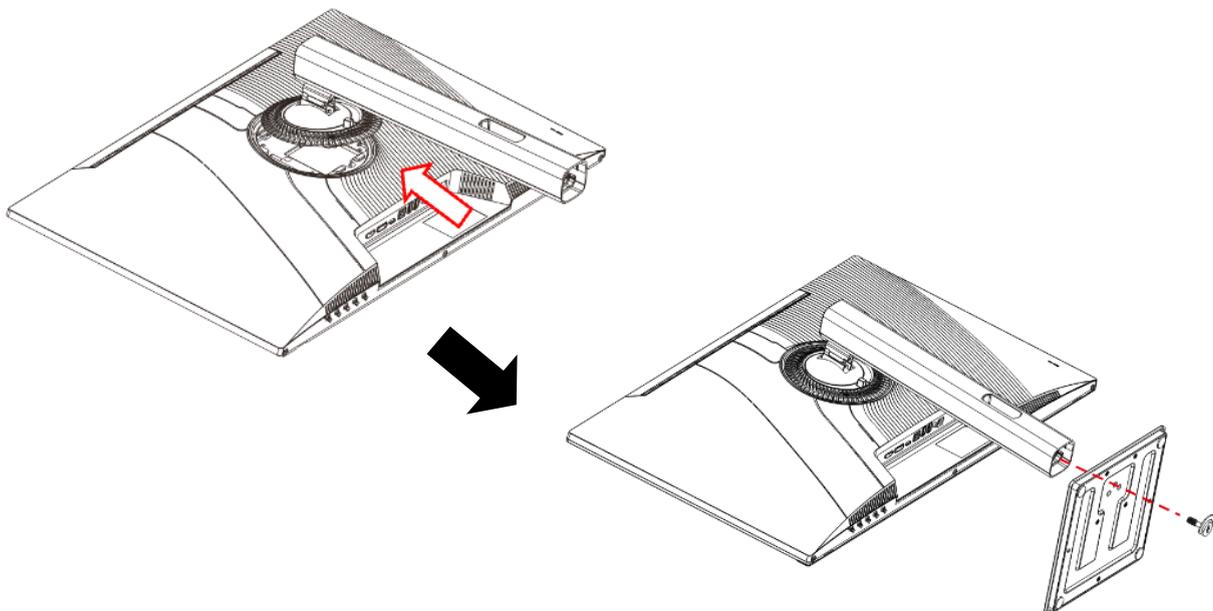
4. Stellen Sie sicher, dass Monitor und Ständer sicher befestigt sind, und heben Sie dann den Monitor langsam an.
